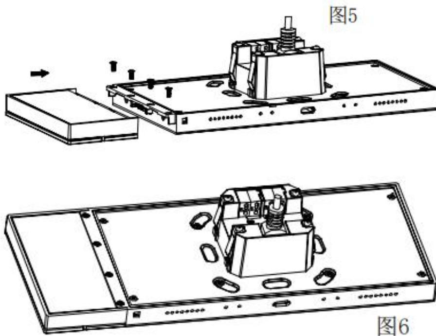
3.将 S7 四键子面板的 6PIN 端子与 KNX 智能屏 S7 的连接座进行组装, 并用之前卸下来的 4 个螺丝进行固定。如图 5 所示; S7 四键子面板与 KNX 中控屏 S7 安装完成, 如图 6 所示;
