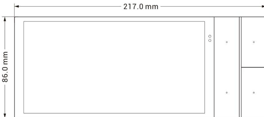
图 3.1.1(2) KNX 智能屏 S7 带四键子面板-底座
