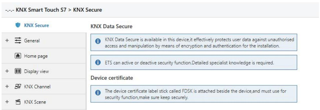
图 5.1 (1) “KNX Secure” 参数界面
