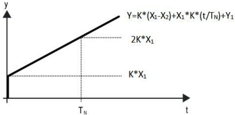
图 5.3.1.2(3) PI 控制方式的控制值
