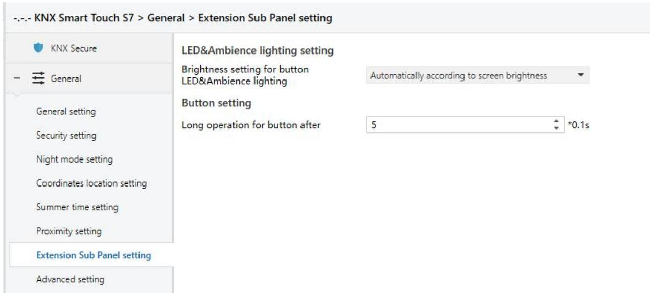
图 5.2.7 “Extension Sub Panel setting”参数设置界面
