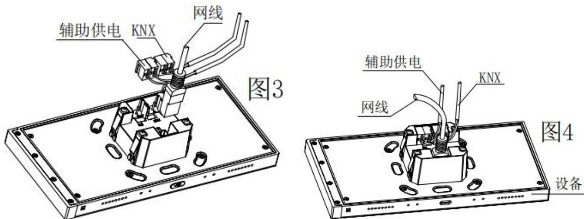
2.将面板上的 KNX 总线连接端子取下，按接线说明进行接线。如图 3 所示；完成接线后，再把接好线的 KNX 总线端子插入设备，并将网线与设备连接好，即可完成接线安装。如图 4 所示；
