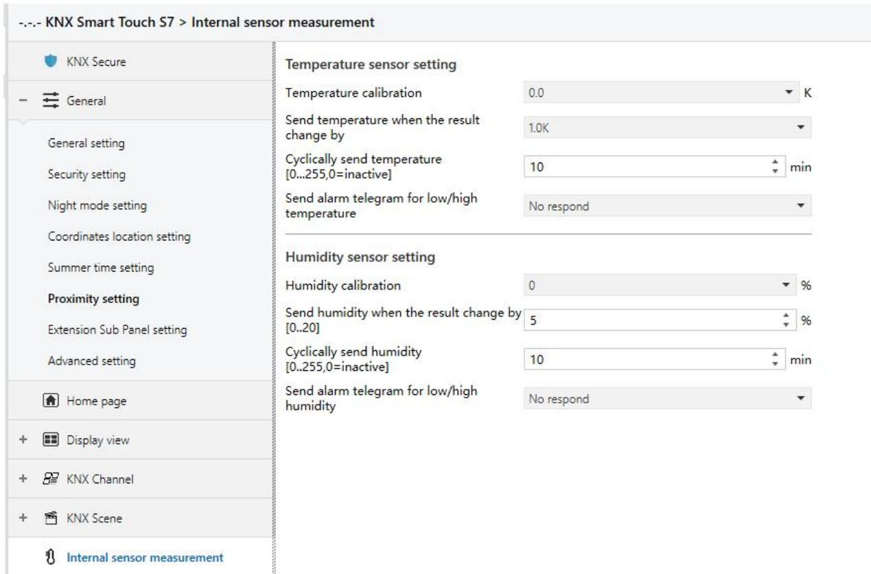
图 5.13 “Internal sensor measurement”参数设置界面
