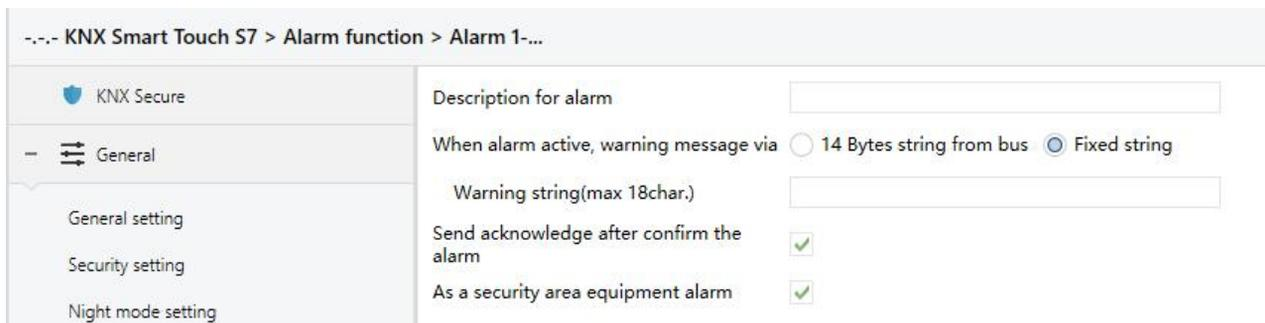
图 5.6.1 “Alarm x”(x=1~24) 参数设置界面
