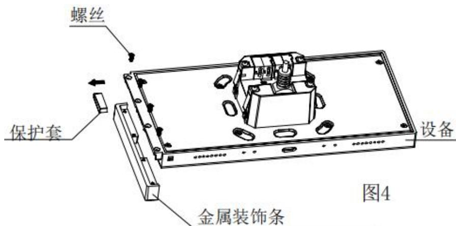
2.用螺丝刀取出 KNX 智能屏 S7 上固定金属装饰条的 4 个螺丝, 并将螺丝保存好。然后取下金属装饰条和套在插针上面的硅胶保护套。如图 4 所示;
