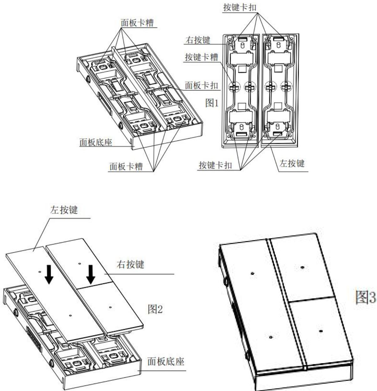
1.取出面板底座和左右按键，辨别左右按键和面板底座的方向，将按键卡扣和面板底座的卡槽对齐，分别向下按压左、右按键，直至按键底部的卡扣完全扣入面板底座内，则按键安全完成。如图 1、图 2、图 3 所示；
