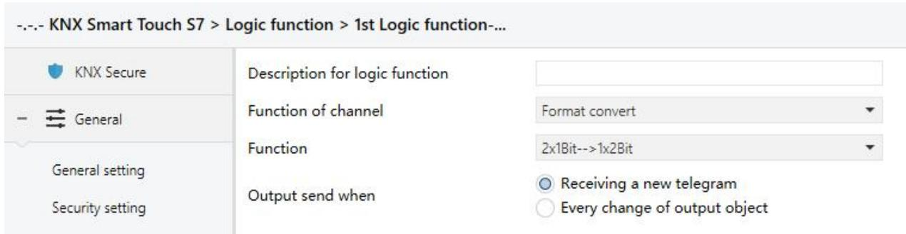
图 5.7.4 “Logic function \_Format convert” 功能参数
